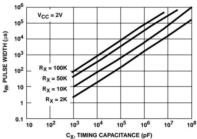
FIGURE 7. HC221 OUTPUT PULSE WIDTH vs  $C_X$
