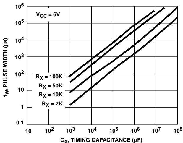
FIGURE 9. HC221 OUTPUT PULSE WIDTH vs  $C_X$
