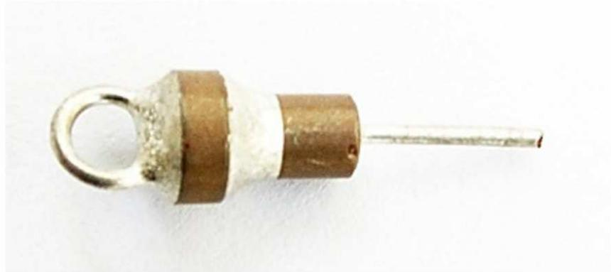
zum einlöten, Ideal für HF dichte Gehäuse
