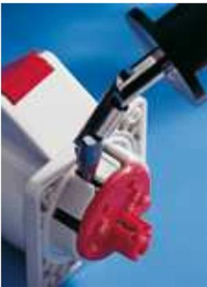
Das Foto zeigt die Prüfung mit dem „VDE-Finger“.
