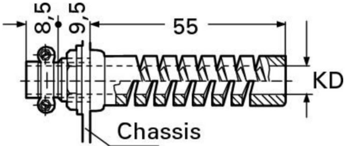
mit Kunststoffknickschutz und Zugentlastung, Kabeldurchlass
