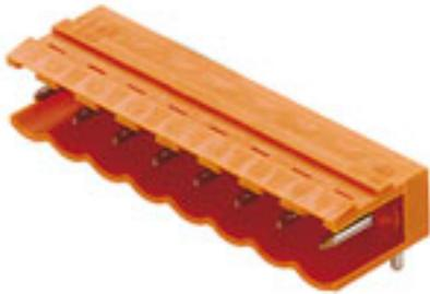
Stiftleisten mit 90° Abgangsrichtung. Die Lötstiftlänge ist für Wellenlötanwendungen optimiert. Die Stiftleisten bieten Platz für Beschriftungen und können kodiert werden. Verpackung im Karton.
