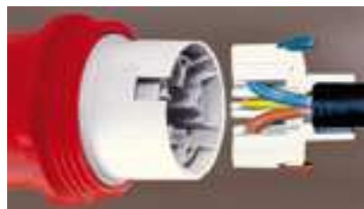
Schnittmodell: Leiter im Verteilerring um 180° abgewinkelt - wirkt als Anker
