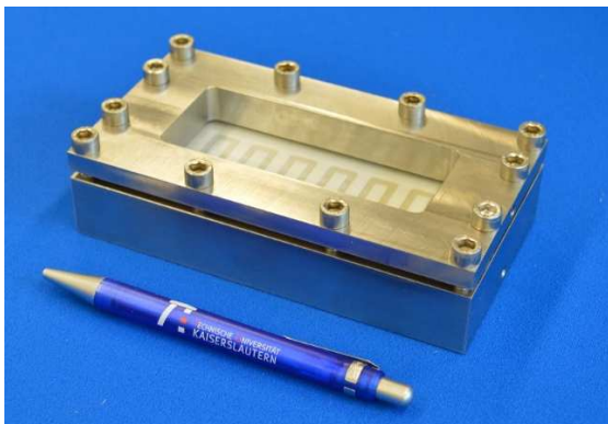
Apparat zur Mikroextraktion von Metallionen.
